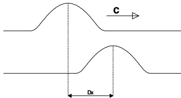
Eine mechanische Welle ist die Ausbreitung einer Störung in einem elastischen Medium. Breitet sich die Störung in der Zeit  $\Delta t$  um die Strecke  $\Delta x$  aus, dann heißt
