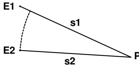
Destruktive Interferenz in einem Punkt P gibt es genau dann, wenn der Betrag der Differenz der Entfernungen von P zu den Erregern, der sog. Gangunterschied, ein ungerades Vielfaches der halben Wellenlänge ist.
