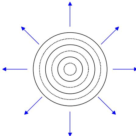
Kreiswellen laufen von einem punktförmigen Erreger nach allen Seiten hin aus. Die Teilchen gleicher Phase sind auf Kreislinien angeordnet.
