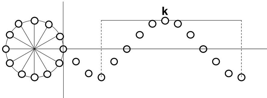
Führt der Wellenerreger speziell eine harmonische Schwingung durch, dann zeigt die Welle Sinusform. Den Abstand benachbarter Punkte, die in Phase schwingen, nennt man Wellenlänge  $\lambda$ .
