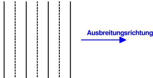
Bei ebenen Wellen schwingen Teilchen gleicher Phase in einer Ebene senkrecht zur Ausbreitungsrichtung der Welle.
