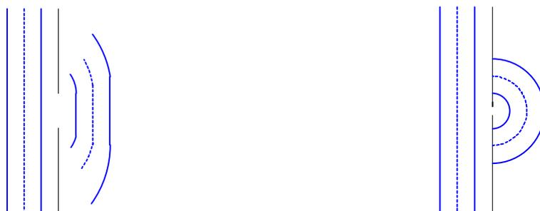
Engt man die Ausbreitung einer ebenen Welle durch einen Spalt ein, dann ergibt sich hinter
