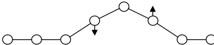
Jedes Teilchen des elastischen Mediums kann infolge der elastischen Kopplung seinen Bewegungszustand (Pha-se) mit einer einer bestimmten zeitlichen Verzögerung seinem Nachbar-teilchen mitteilen. Es kommt zu sog. phasenverschobenen Bewegungen. Die Geschwindigkeit der Teilchen, die sog. **Schnelle**, ist von der Wellengeschwindigkeit  $c$  verschieden.
