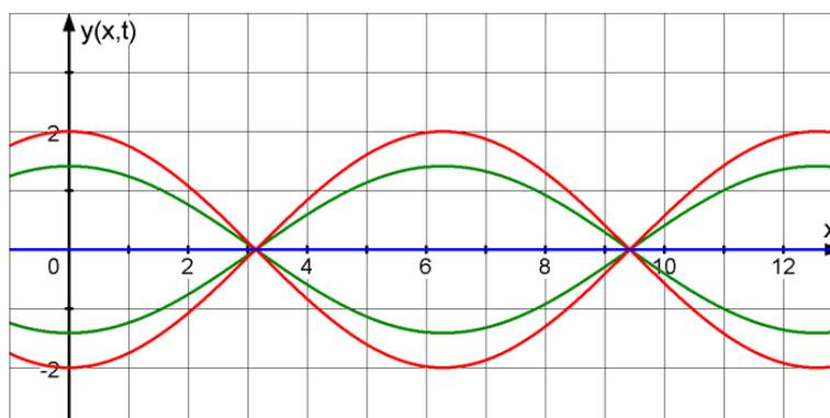
Bild einer stehenden Welle zu den Zeiten  $t = 0$  und  $t = \frac{T}{2}$  (blau),  $t = \frac{T}{4}$  und  $t = \frac{3}{4}T$  (rot) und  $t = \frac{T}{8}$ ,  $t = \frac{3}{8}T$ ,  $t = \frac{5}{8}T$  und  $t = \frac{7}{8}T$  (grün).
