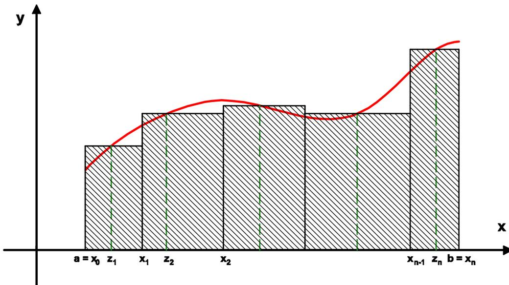
Das bestimmte Integral  $\int_a^b f(x)dx$  einer integrierbaren Funktion  $f$  erhält man auch, wenn man eine einzige Folge von Rechtecken zur Approximation benützt.
