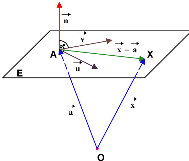
Ebenengleichung in Parameterform :  $\vec{x} = \vec{a} + \lambda \cdot \vec{v} + \mu \cdot \vec{u}$
