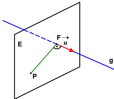
Man legt durch P eine Ebene E, die zur Geraden g senkrecht verläuft. Als Normalenvektor von E kann der Richtungsvektor von g dienen.
