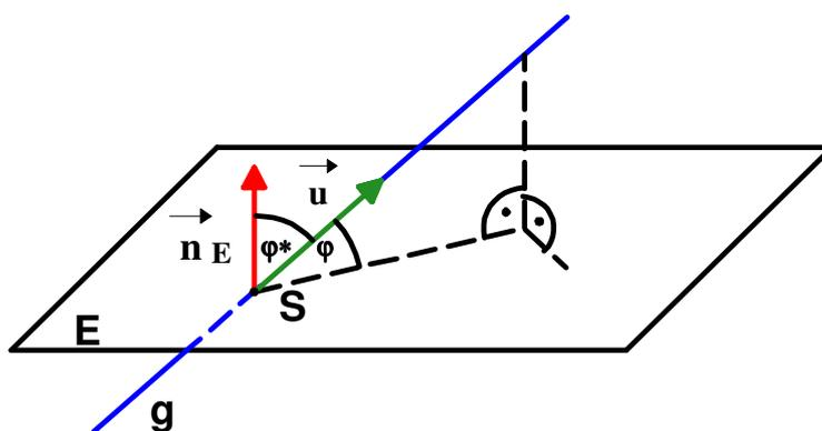
Der Schnittwinkel, unter dem eine Gerade eine Ebene schneidet, ist gleich dem Komplement des spitzen Winkels, den der Richtungsvektor der Geraden mit einem Normalenvektor der Ebene bildet.
