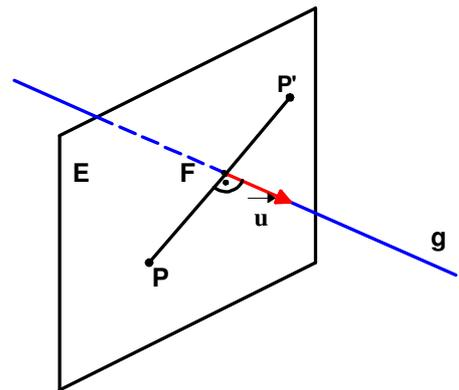
Man legt durch den zu spiegelnden Punkt eine Ebene E senkrecht zur Spiegelachse g. Der Lotfußpunkt F ist dann der Schnitt von g mit E. Es gilt dann
