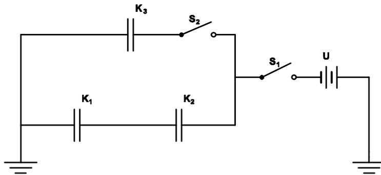
Bei geschlossenem Schalter  $S_1$  und geöffnetem Schalter  $S_2$  werden die beiden Kondensatoren  $K_1$  und  $K_2$  mit  $C_1 = 3,0 \text{ }\mu\text{F}$  und  $C_2 = 2,0 \text{ }\mu\text{F}$  durch die Spannungsquelle -  $U = 25 \text{ V}$  - aufgeladen.
