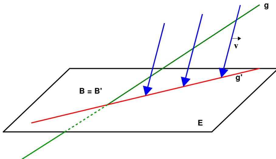
Bild : Parallelprojektion einer Geraden in eine Ebene
